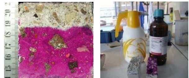
Figure 03: Test à la phénolphthaléine et mesure du front de carbonatation
