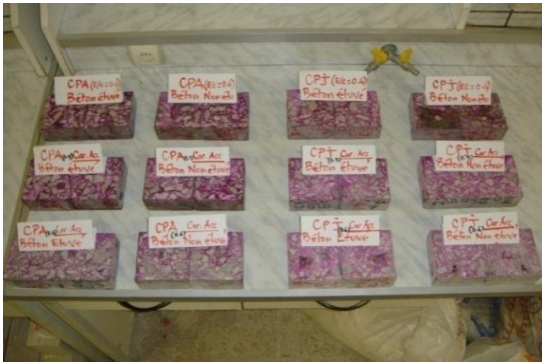
Figure 04 : Mise en évidence des fronts de carbonatation visualisés suite à la pulvérisation à la phénophtaléine des 03 types de bétons (étuvage, air, eau) en carbonatation accélérée
