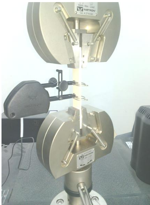
Figure 06: Machine de traction avec extension-mètre
