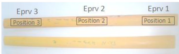
Figure 09: Schéma de l'éprouvette de traction utilisé coupe longitudinale de la grappe
