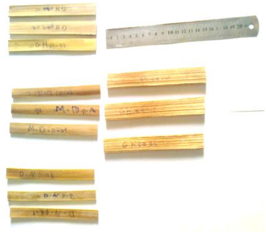
Figure 07: Schéma de l'éprouvette de traction utilisée
