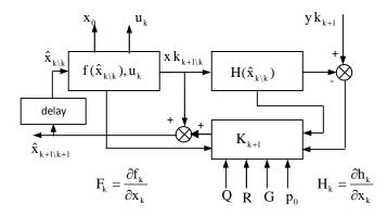
Fig. 4. EKF bloc diagram.
