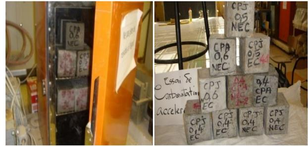
Figure 02 : Éprouvettes (10×10×10) cm<sup>3</sup> dans l'enceinte de carbonatation en conditions accélérées
