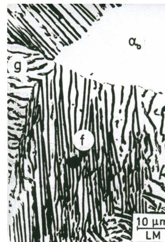
Figure 3 : Morphologie du précipité lamellaire dans l'alliage Cu-7,5At.-%In, homogénéisé, trempé, ensuite vieilli pendant 3,5 heures à  $392^\circ\text{C}$  [17]
