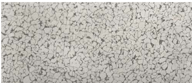
Figure 1 : Microstructure du fil machine de l'acier doux (0.05%C)
