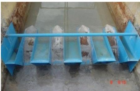
Figure 10: Modèle de PK-Weir (A1,3) et coupe transversale de l'alvéole aval avec radier incliné en deux pente différentes
