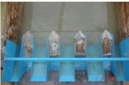
Figure 11: Modèle de PK-Weir (A1.4) et coupe transversale de l'alvéole aval avec radier incliné dans la partie amont et horizontal à l'aval
