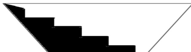
Figure 15: Modèle de PK-Weir A1.6 et coupe transversale de l'alvéole aval avec radier en marches d'escalier
