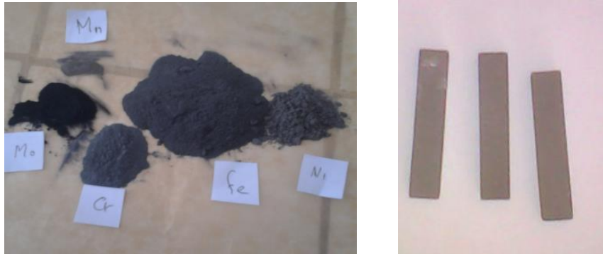
Fig. 2. Exemple de poudres pour un acier 316L fritté
