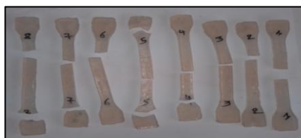
Figure 7. Eproutettes normalisées en résine après l'essai de traction.
