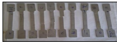
Figure 2. Les éprouvettes minces endommagées après l'essai de traction.
