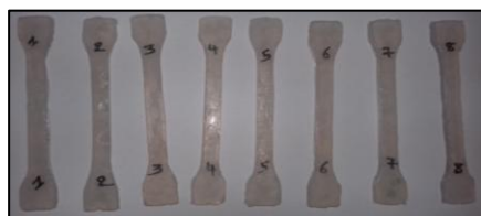
Figure 6. Eproutettes normalisées en résine avant l'essai de traction.
