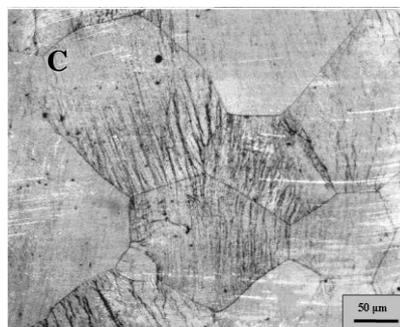
Figure 1. Microstructure des échantillons de l'alliage Al-5.8%Zn-2.7%Mg, A: Etat brut (B), B : Etat Homogénéisé (H) et C : Etat Homogénéisé+Déformé (H+D)
